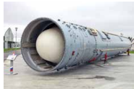
Межконтинентальная баллистическая ракета шахтного базирования УР-100Н / УР-100Н УТТХ
