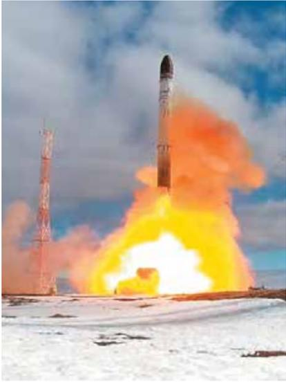
**РС-28 «Сармат» (по классификации НАТО: SS-X-30) – российский стратегический ракетный комплекс шахтного базирования пятого поколения с тяжёлой многоступенчатой жидкостной МБР. «Сармат» предназначен для замены советских ракет Р-36М2 «Воевода», находящихся на вооружении РВСН.**
