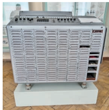
Специализированная ЭВМ для оперативного расчета полетного задания дежурной сменой ракетного полка. Опытный образец был создан и отработан в институте, также разработана технология её изготовления и передана в серийное производство в организации промышленности
