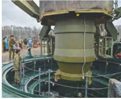
В Козельском ракетном соединении (Калужской области) провели загрузку межконтинентальной баллистической ракеты «Ярс» в шахтную пусковую установку (ШПУ). Ракета устанавливается в ШПУ с помощью специального транспортно-загрузочного агрегата. Сложнейшие технологические операции длятся несколько часов.
